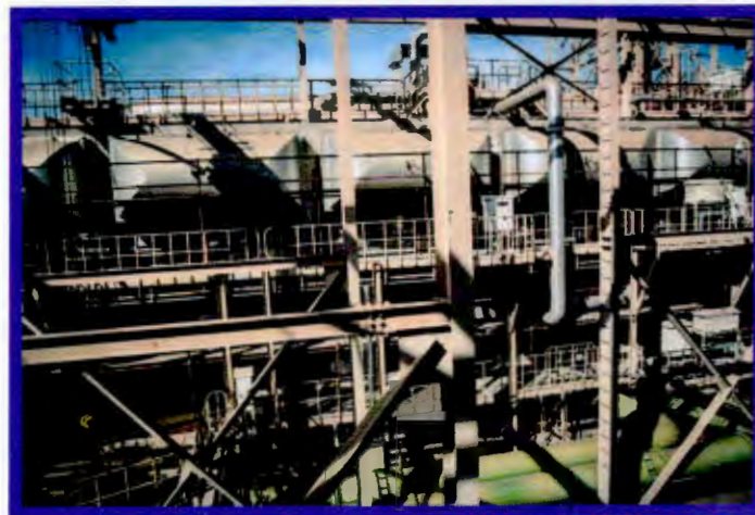
مقطرة مياه بتقنية التبخير الومضي المتعدد المراحل Multi Stage Flash evaporation method distiller
